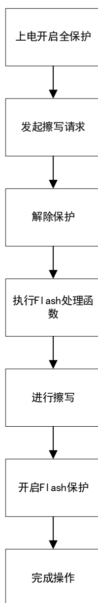
图 1 Flash 保护流程图
